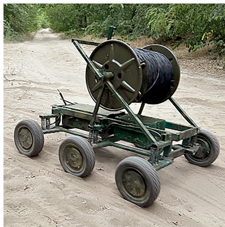
Рис. 7. РТКс для прокладки кабельных линий связи
