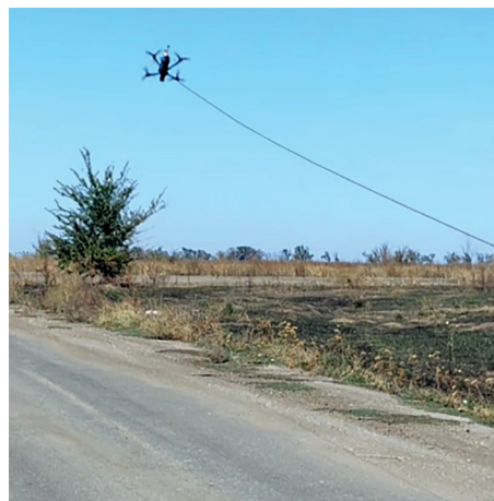
Рис. 5. Прокладка полевого кабеля РТКс
