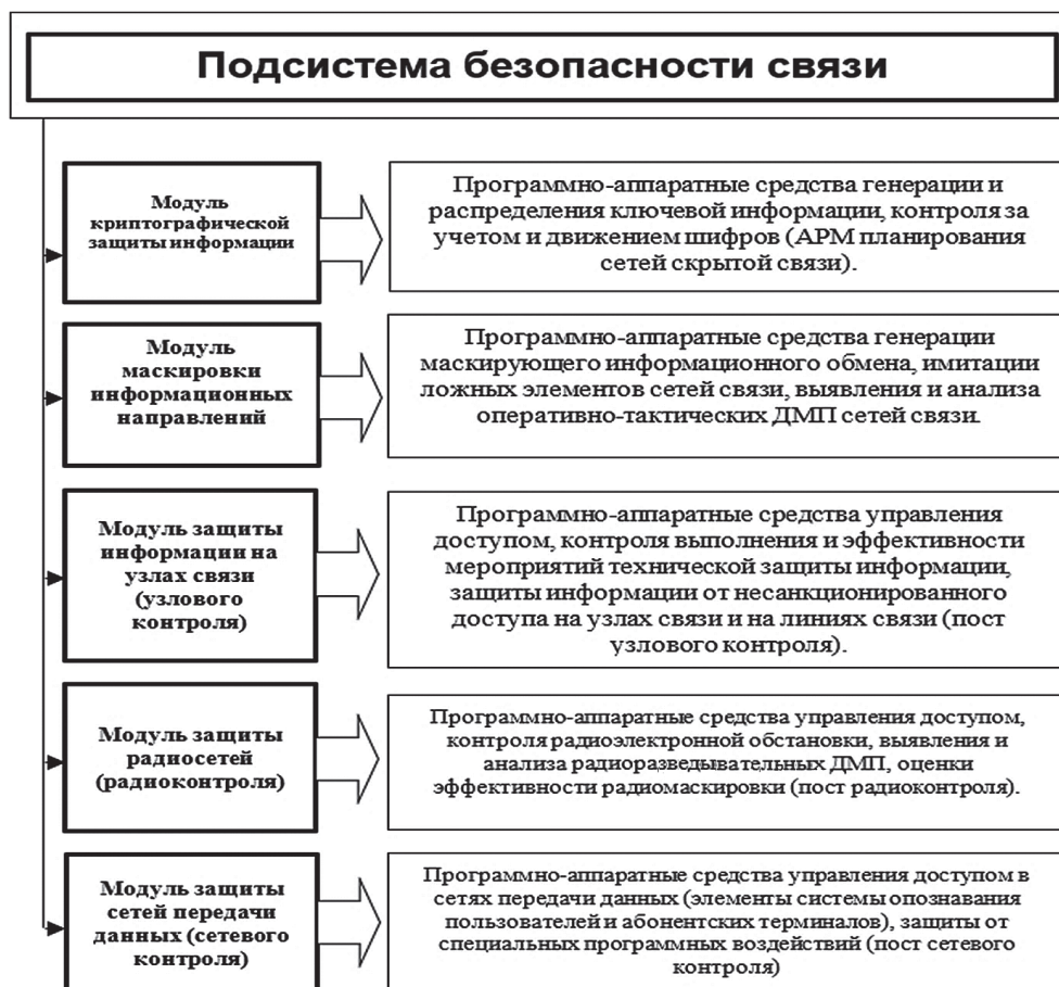
Рис. 2. Структура подсистемы безопасности связи ИТКС ВН
