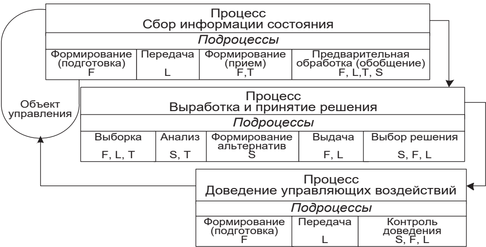
Рис. 3. Структура информационного процесса в системе управления РТК СН
