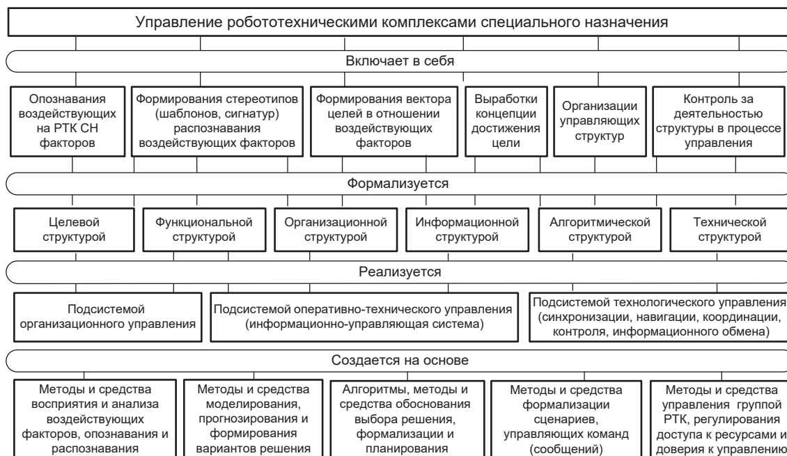
Рис. 6. Обобщенная схема организации управления РТК СН (разработано авторами)
