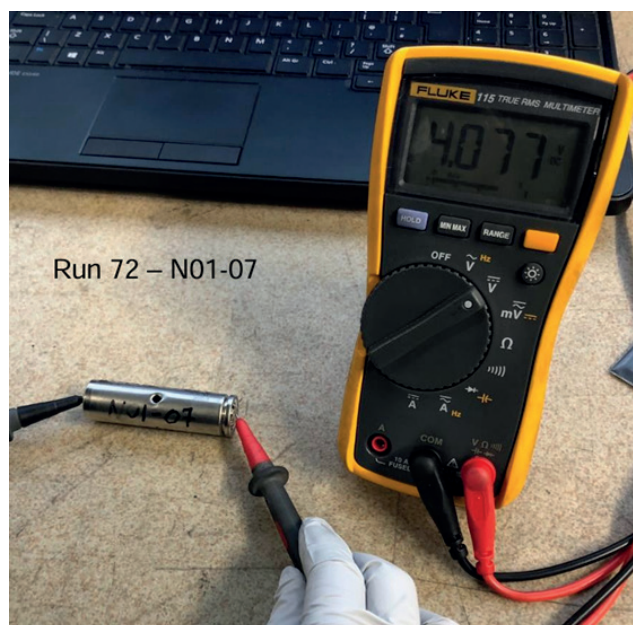
Рис.10. Литий-ионный аккумулятор с применением оплавляемых токоотводов после прокола
