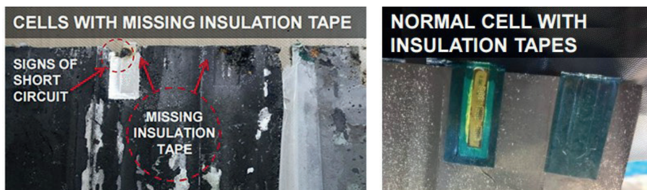
Рис.7. Отсутствие изоляционной ленты на поверхности токоотвода катода в литий-ионном аккумуляторе Samsung Galaxy Note 7 [3]
