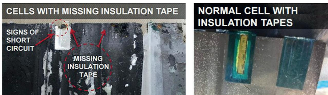
Рис.7. Отсутствие изоляционной ленты на поверхности токоотвода катода в литий-ионном аккумуляторе Samsung Galaxy Note 7 [3]
