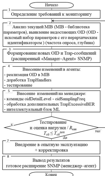
Рис. 2. Алгоритм разработки и внедрения расширенного протокола SNMP
