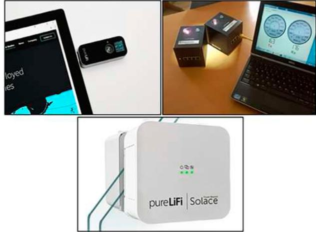
Рис. 4. Оптические приемники технологии Li-Fi
