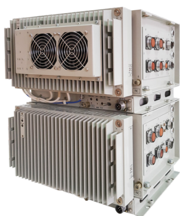
Рис.1 Радиорелейная станция Р-419МР
