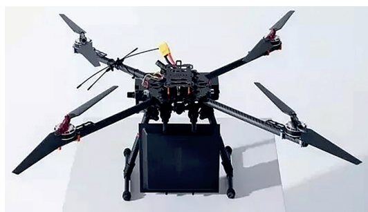
Рис. 4. Вариант размещения оборудования БШПД на БПЛА
